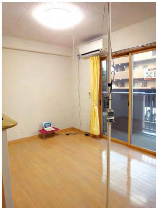
写真 2 エアコンの消費電力の測定風景
