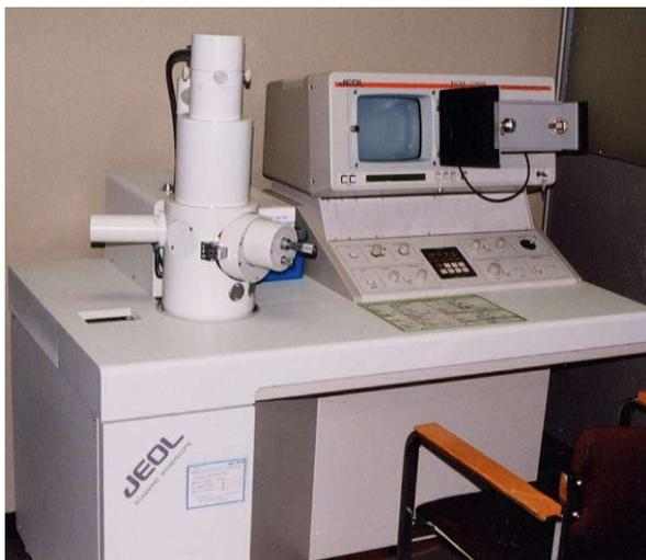
(図2) 走査型電子顕微鏡
