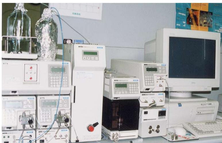
(図4) 高速液体クロマトグラフィ
